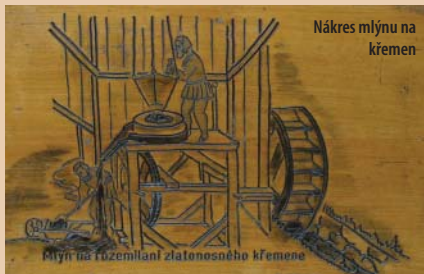
Mlýn na ruční mlácení zlatonosného křemenu
