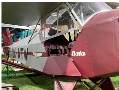
Taylor E2 Cub s novými křídly a původním nátěrem
